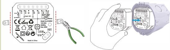
È possibile rimuovere il supporto a vite sul modulo con una pinza se non è possibile inserire il modulo nella scatola di derivazione.
