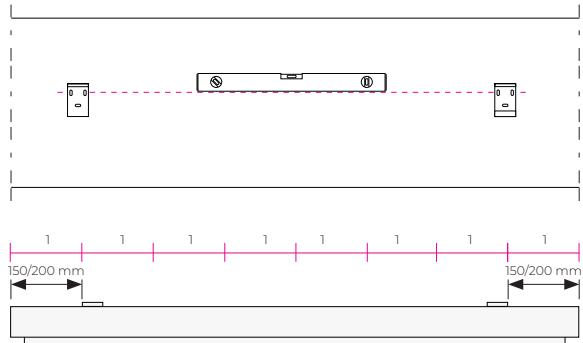
Le staffe devono essere posizionate ad una distanza di circa 150/200 mm dal lato destro e dal lato sinistro. Calcolato l'interasse dei fori si procede ad effettuare i fori sul supporto. È possibile installare le staffe al supporto sia verticali sia a soffitto.
