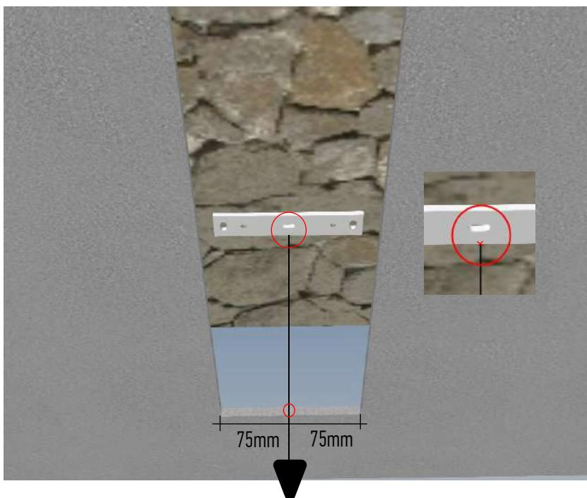
Con l'aiuto di laser o piombino rilevare il punto di installazione delle staffe. Prendere come riferimento il punto centrale del taglio del controsoffitto. 75mm
