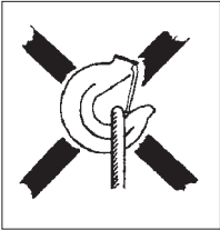
Fig 2a L'imbragatura è posta sulla punta del gancio.
