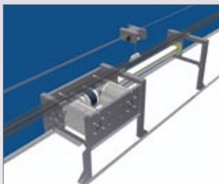
Gruppo motore: i riduttori angolari sono coadiuvati da un freno elettromeccanico.
